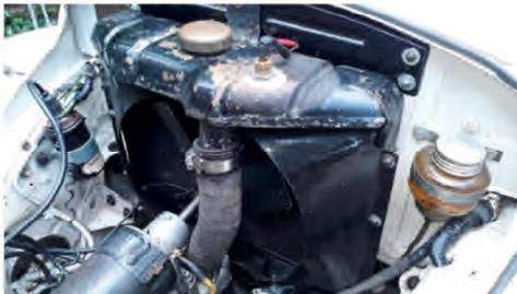
Die entstehende Schutzschicht behindert aber auch in geringem Maße den Wärmeübergang von Motorteilen auf das Wasser und vom Wasser an die Kühlerflächen. Den Motoren der Topolinos macht das nichts aus. Da moderne Motoren mit hoch-effizienten Kühlsystemen diese Silikat haltigen Zusätze aber nicht mehr vertragen, sind die allermeisten verkauften Frostschutzmittel inzwischen frei von
