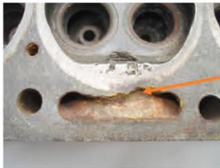
Durch Korrosion weggefressene Fläche für die Zylinderkopfdichtung: Da hilft auch keine neue Dichtung. Durch Aluschweißen und Planen kann der Zylinderkopf vielleicht noch gerettet werden.
