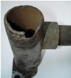
Schadhaftes Wasserrohr am B-Motor
